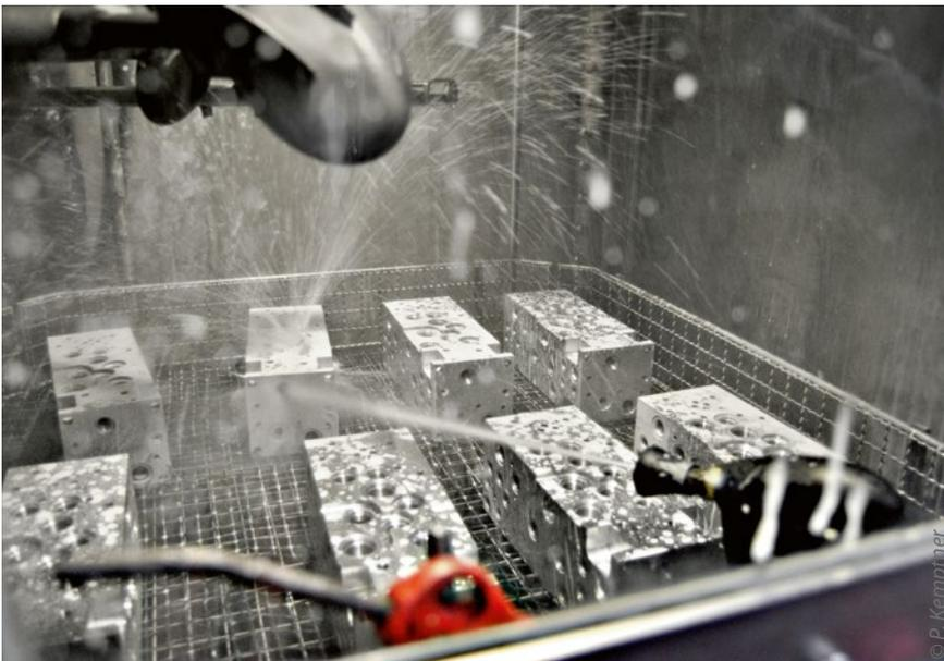
Die Reinigungsanlage ist mit einer Hochdruck-Lanze für bis zu 250 Bar Spritzdruck ausgestattet
